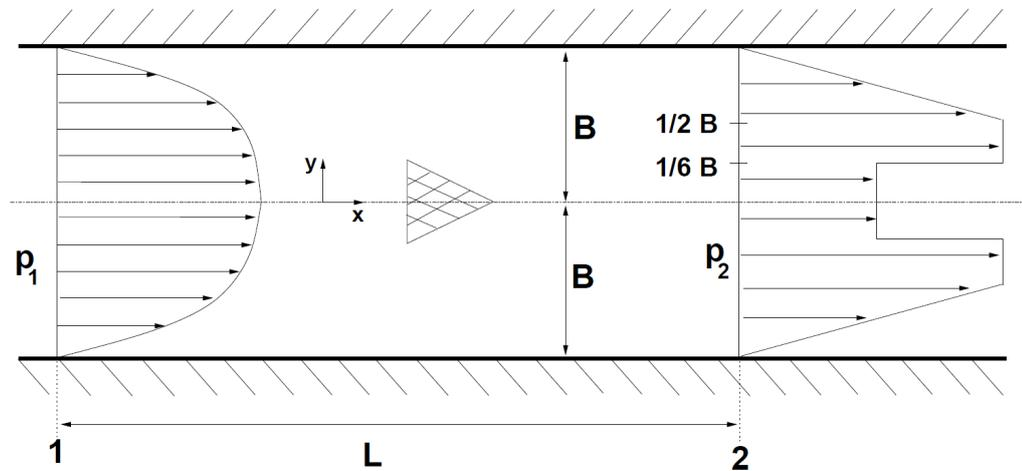
In einem Rechteckkanal der Breite  $2B$  und der Tiefe  $T$  (senkrecht zur Zeichenebene) ist ein kleiner, dreiecksförmiger Körper eingespannt. Die abgebildete Form ist konstant über die Tiefe  $T$ . Der Kanal wird von einem inkompressiblen, reibungsbehafteten Medium (Dichte  $\rho$ , Viskosität  $\eta$ ) stationär durchströmt. Im Querschnitt 1 wird die Geschwindigkeitsverteilung
