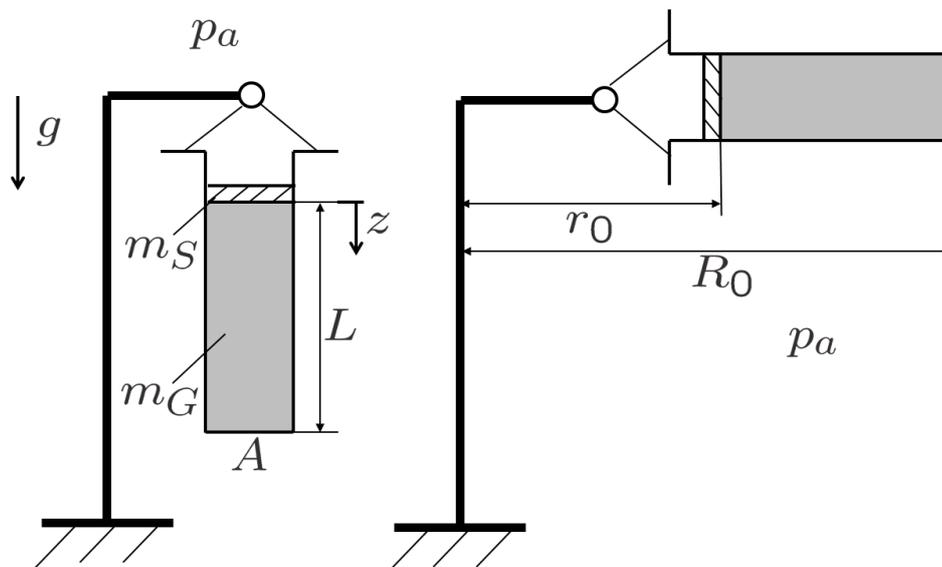
a) Bestimmen Sie die Länge  $L$  der Gassäule vor Betrieb der Zentrifuge.
