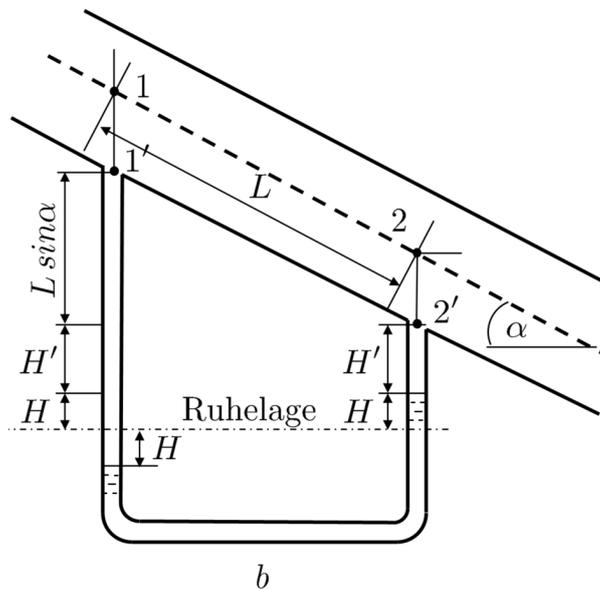
Das hydrodynamische Gleichgewicht für die Mannometerflüssigkeit lautet:
