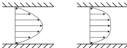
Das turbulente ist völliger als das laminare Geschwindigkeitsprofil, da der Impulsaustausch in radialer Richtung größer ist.
