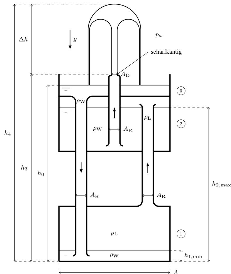
Zu Beginn betragen die Wasserspiegelhöhen im Auffangbecken  $h_0$ , im oberen Reservoir  $h_{2,\max}$  und im unteren Reservoir  $h_{1,\min}$ .
